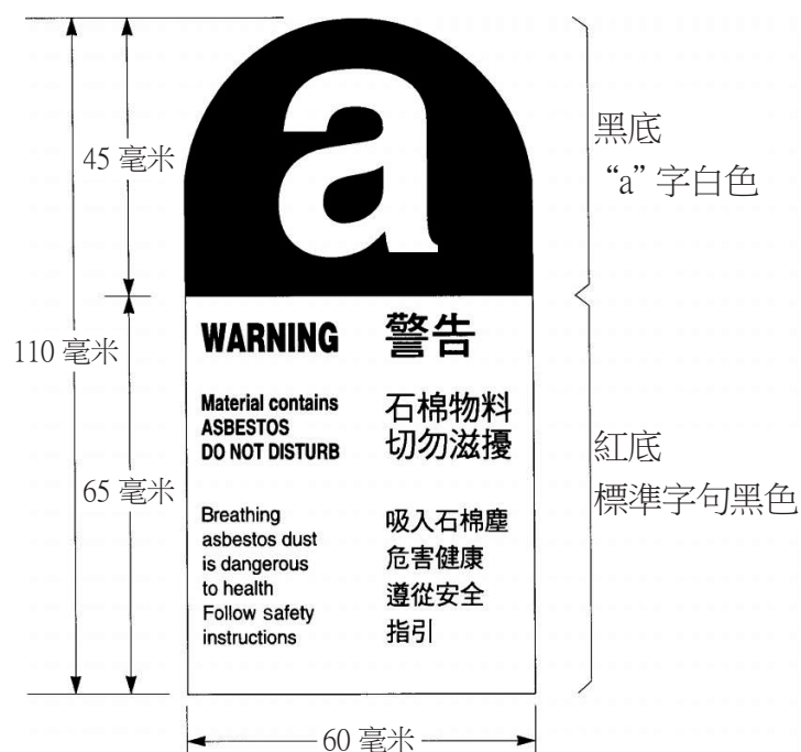
環保署建議的含石棉物料警告標籤
